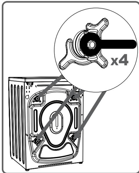
Transportne vijke nakon odvijanja izvucite povlačenjem prema van. Postavite plastične čepove koji se nalaze u vrećici s priborom na mjesta sa kojih su uklonjeni transportni vijci. Spremite transportne vijke i gumene odstojnike za eventualni naknadni transport perilice.
