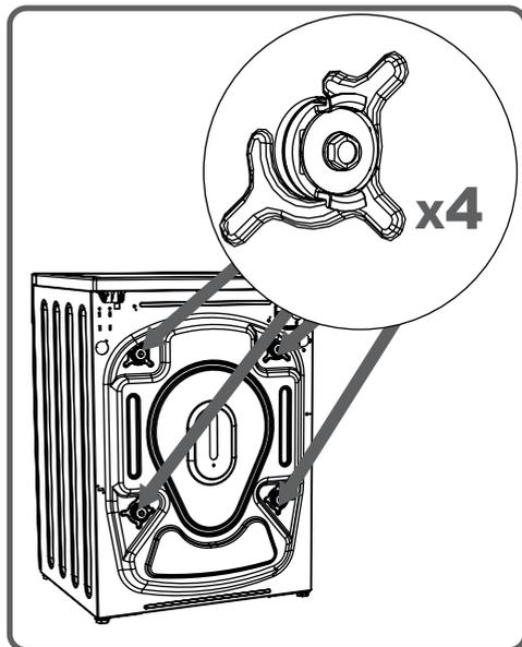
Transportni vijci se uklanjaju tako da ih se pomoću odgovarajućeg ključa okrene u smjeru suprotnom od smjera kretanja kazaljki na satu.
